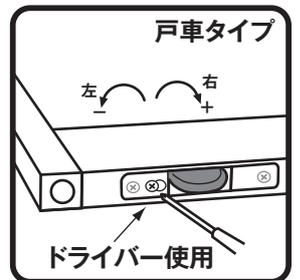
戸車の調整ネジをドライバーで回すと高さ調整でき、すき間対策となります(上下5mm)
